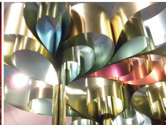
表面にイオンプレーティング、裏面に陽極酸化を施したゴールド+発色チタン
