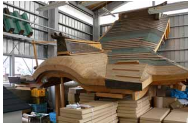
技術研修センター内の屋根模型。ここで実践的指導が行われる
