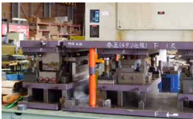
チタン瓦の量産を実現したプレス機。装置自体は銅瓦のプレス機と同様だが、数々のノウハウを駆使して運用される
