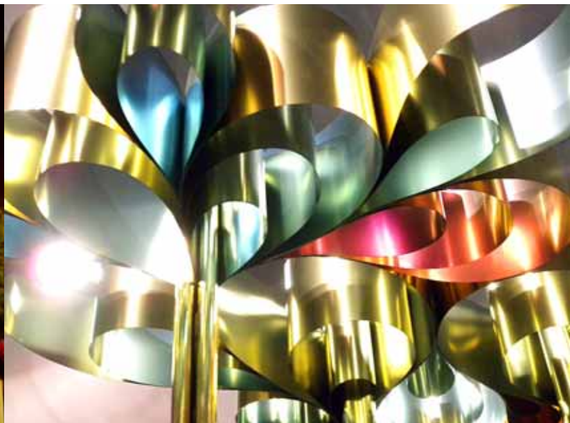
イオンプレーティング法と陽極酸化法を表裏に併用したチタンの発色例
